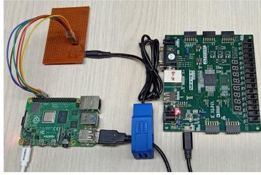
Fig. 9: PUF Enabled Smart Meter Prototype
